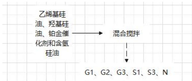
图 2-4 液态硅胶搅拌测试流程图
