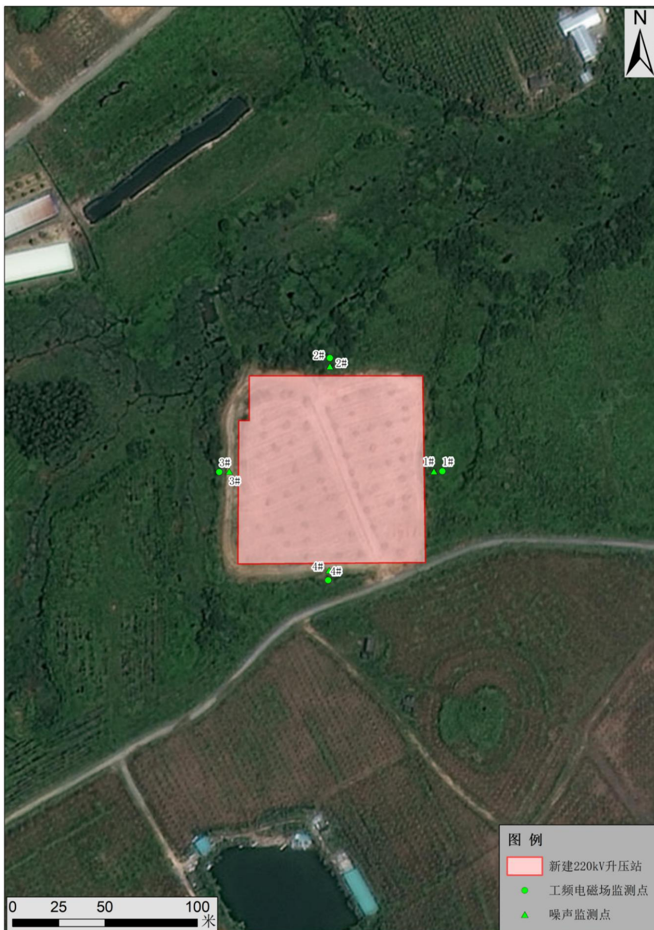
ZT 图 8-1 工频电磁场监测点位示意图
