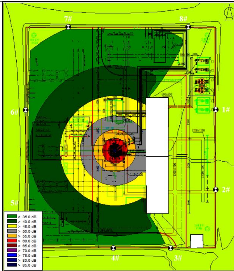
图9 变电站本期规模噪声预测的声等值线图
